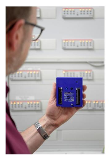
KI im Handformat: Der intelligente Mikrocontroller des Fraunhofer ITWM, der in der Hutschiene des Schaltschranks verbaut wird. © Fraunhofer ITWM
