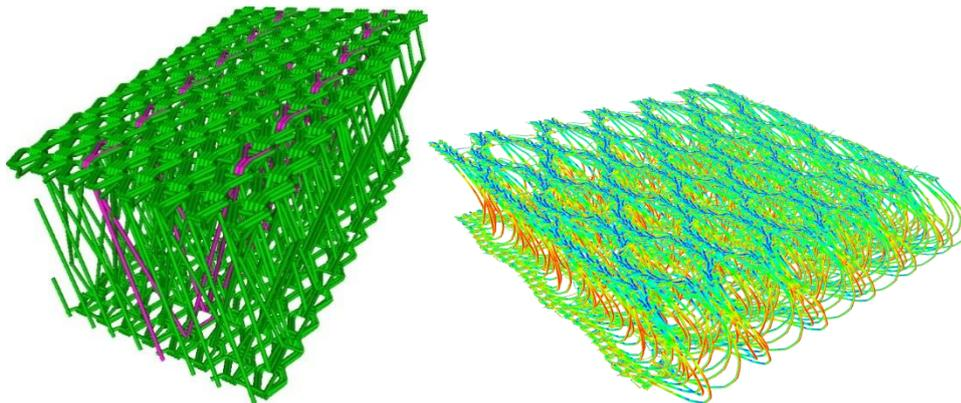
Visualisierung mit Markierung einzelner Garne, Simulation vom Zug in der Ebene und weitere Kompression mit Software. TexMath. ©Fraunhofer ITWM
