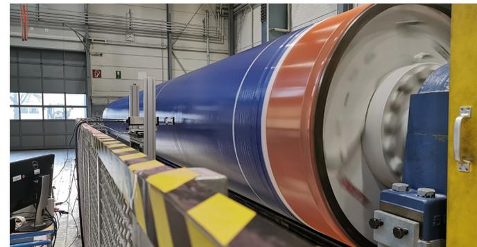
Oben: Flächige Untersuchung von Pressmäntel auf innere Defekte. Die automatische Auswertung auf KI-Basis findet im Hintergrund statt.
