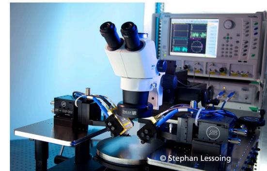
*Netzwerkanalysator mit Hochfrequenzmessspitzen*
