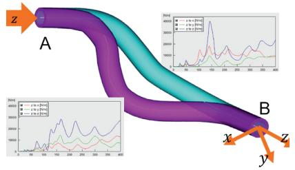
Zwei unterschiedlich vorgeformte Schläuche; für beide werden Einträge der Impedanz-Matrix geplottet und verglichen. Die starke Geräuschübertragung bei ca. 150 Hz kann durch eine Anpassung der Schlauchkrümmung deutlich reduziert werden.
