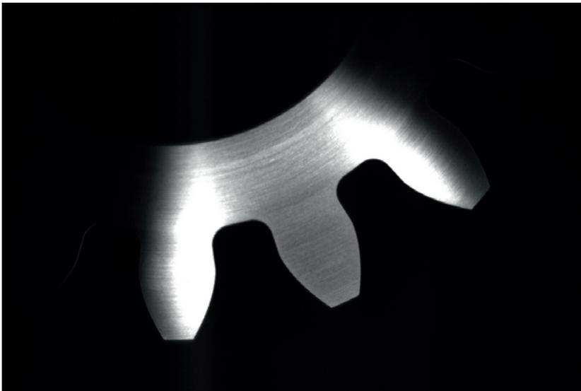
*Hier ist gut zu sehen, dass bestimmte Bereiche im Bild übersteuert sind. Eine sichere Fehlerdetektion ist dort nicht möglich.*
