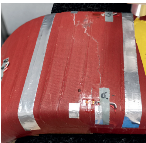
Im Foto links ist ein Teilstück eines Generatorstabs abgebildet. Das rechts im Hintergrund dargestellte Röntgen-CT-Bild des Probenquerschnitts, zeigt einen Riss im Inneren der Isolierung. Die eingebettete Terahertz-Aufnahme zeigt in einer anderen Perspektive, dass sich der Riss über die gesamte Breite des Generatorstabs erstreckt.
