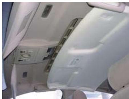
Im Audi A6 eingebauter Dachhimmel
