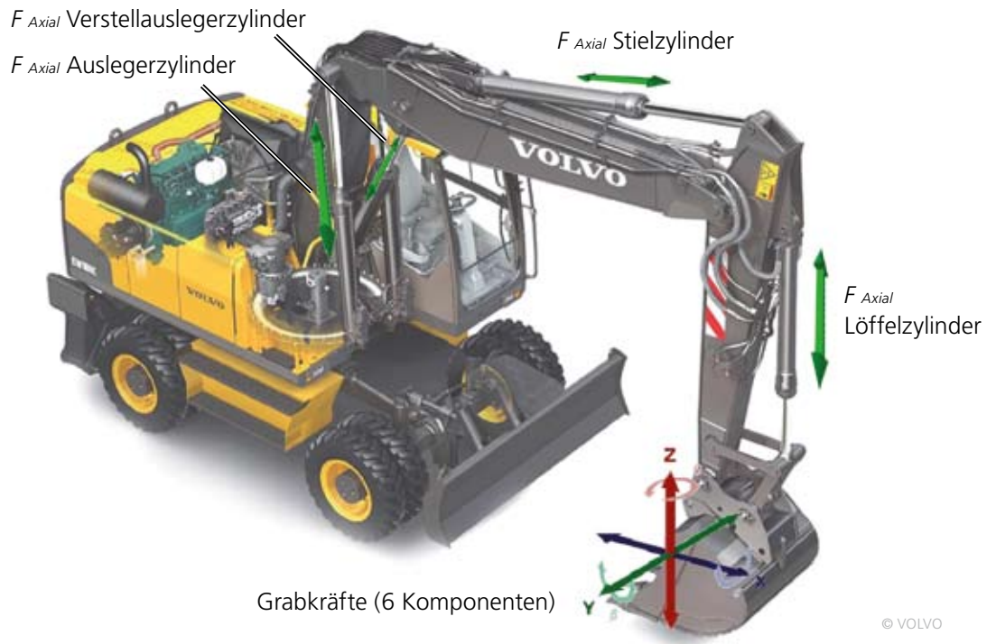
Lastdatenerfassung (Kräfte und Momente) an der Arbeitsausrüstung eines Mobilbaggers
