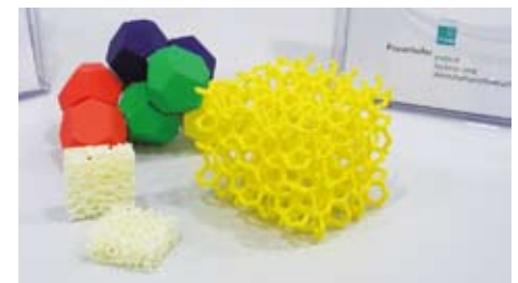
Workshop-Exponate: die gelbe Gitterstruktur stammt vom 3D-Drucker des ITWM
