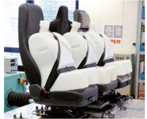
Prüfaufbau für dynamische Beanspruchung der Sitze bei KEIPER
