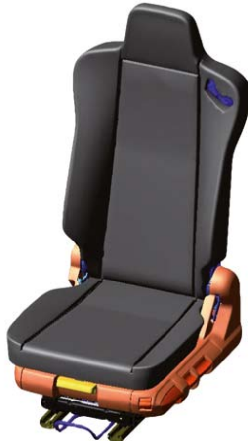
Vom ITWM erstelltes virtuelles Sitzmodell zur Untersuchung dynamischer Beanspruchung
