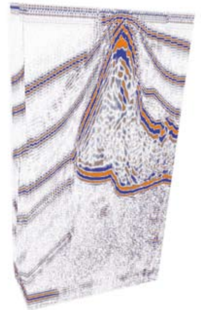
Mit 3D-GRT migriertes Volumen des SEG-EAGE-Salzstockdatensatzes
