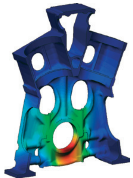
Formoptimierung mittels DDFEM: Verzerrungen innerhalb eines Motorblocks. Das verwendete tetrahedrale Netz sowie die Spannungen für dasselbe Bauteil sind auf Seite 42 zu finden.
