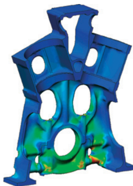
Von-Mises-Vergleichsspannung für das Motorsegment bei maximalem Gasdruck im Zylinder und kritischem Drehwinkel der Kurbelwelle
