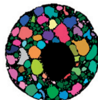
Mineralschaumkugel vom Typ KeraPlus oben: 3D-Visualisierung, ange-schnitten Mitte: Schnitt durch rekonstruierte tomographische Aufnahme unten: gleicher Schnitt mit segmentierten und getrennten Poren
