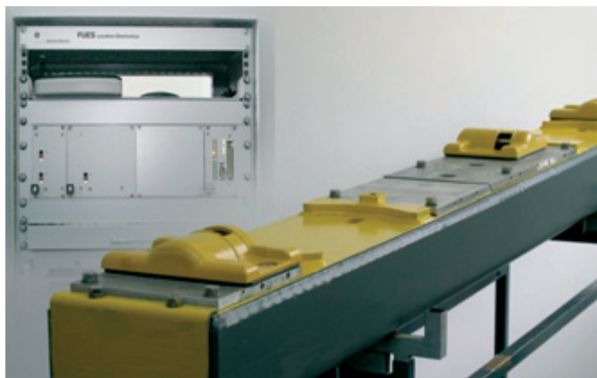
FÜS-Mess-Schwelle mit Steuerschrank
