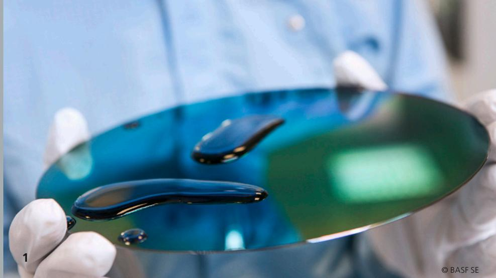
1 *Labormitarbeiter testet die Benetzungseigenschaften eines Siliziumwafers.*
